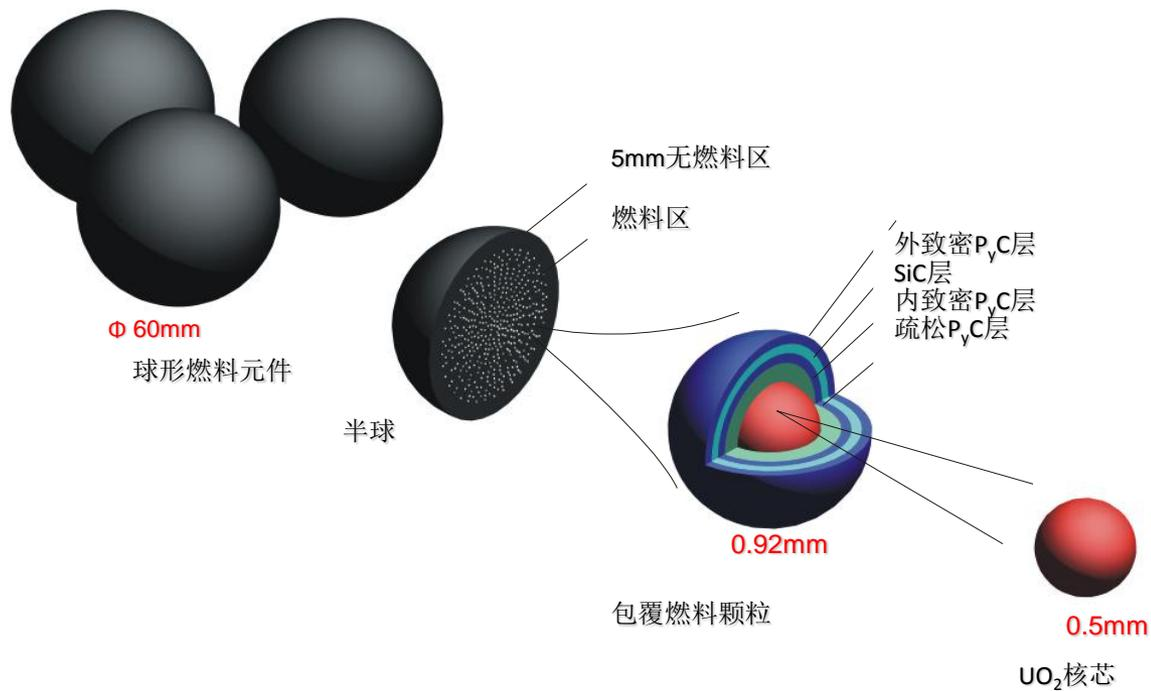
高温气冷堆球形燃料元件示意图
